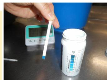
←残留塩素試験紙で100ppmを必ず確認
